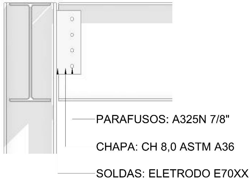
Figura 17 - Ligação Tipo LCHS
